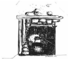
Même si la voûte est à l'extérieur, le four communique avec l'intérieur par les portes qui s'ouvrent dans le contrecoeur de la cheminée. Saint-Hilarion (C lé de Charlevoix) Collection Blanchette, Archives du C.C.E.C.T., cote 104 intérieur
